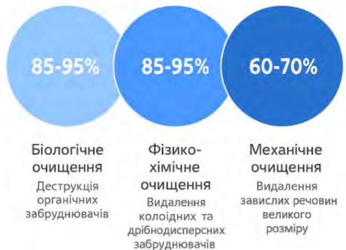
Рис. 2. Основні стадії очищення стічних вод целюлозно-паперових підприємств та їх ефективність
