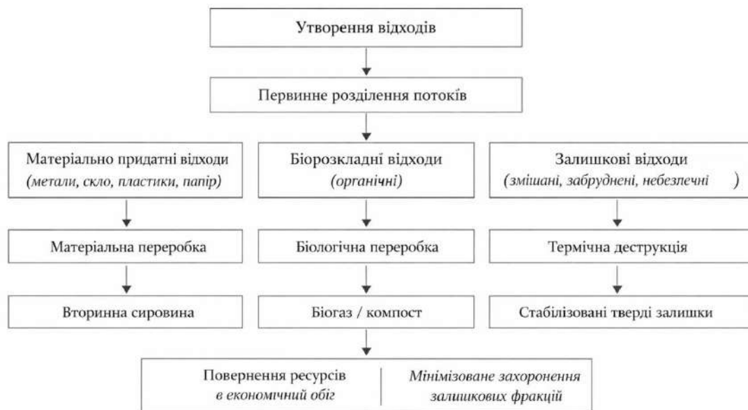
Рисунок 1 – Взаємодія термічної деструкції з матеріальною та біологічною переробкою в системі циркулярної економіки.
